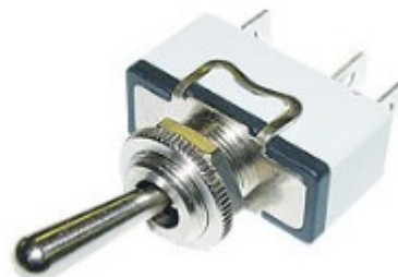
Kippschalter Metallhebel mom-on HD 15A 0<-1 12V-15A 24V-10A ø 12mm / 6,3mm
