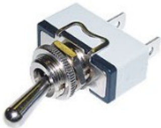
Kippschalter Metallhebel on-off HD 15A 0 - 1 12V-15A 24V-10A ø 12mm / 6,3mm
